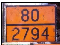
Figura 2.2 – pannello ai sensi della normativa ADR. Si possono osservare: in alto il numero d'identificazione del pericolo (numero kemler: 8=corrosivo) per un carico di batterie esauste; sotto il numero di identificazione (ONU) della medesima merce.
