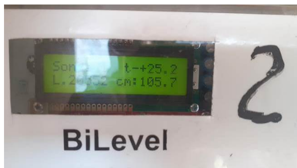
Figura 2.16– display del sistema di controllo del livello del serbatoio n. 2
